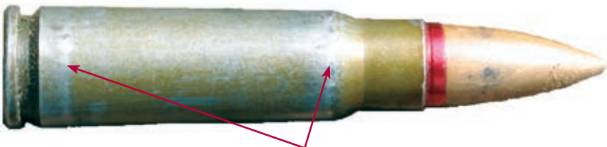
Figure 11 Laque érodée (sur acier) sur une cartouche de 7,62 x 39 mm
